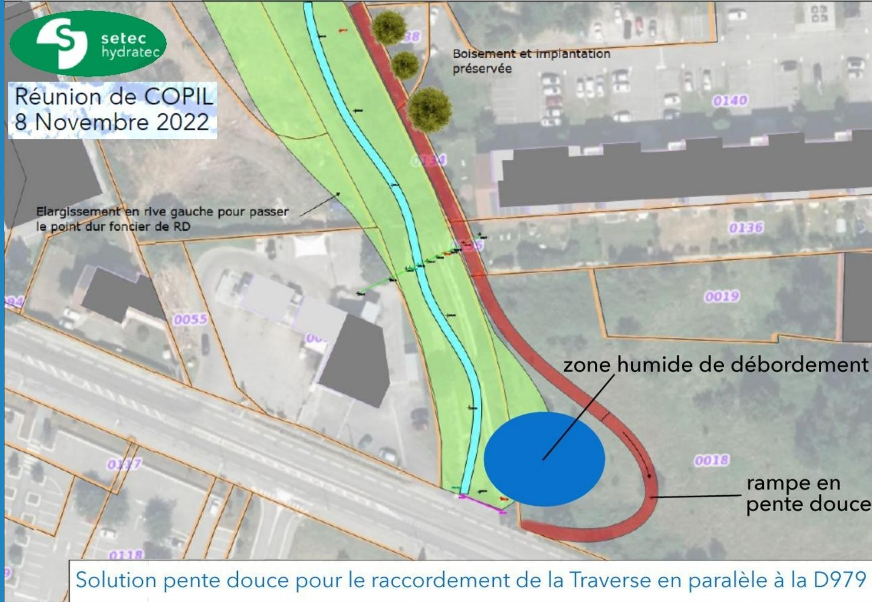
Solution pente douce pour le raccordement de la Traverse en parallèle à la D979
